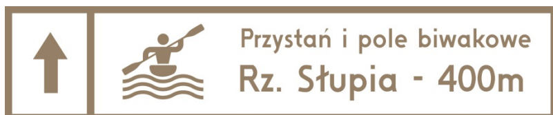
Rysunek 3 Rekomendowane zmiana zawartości graficznej informacyjnego znaku drogowego na bazie znaku E-7
